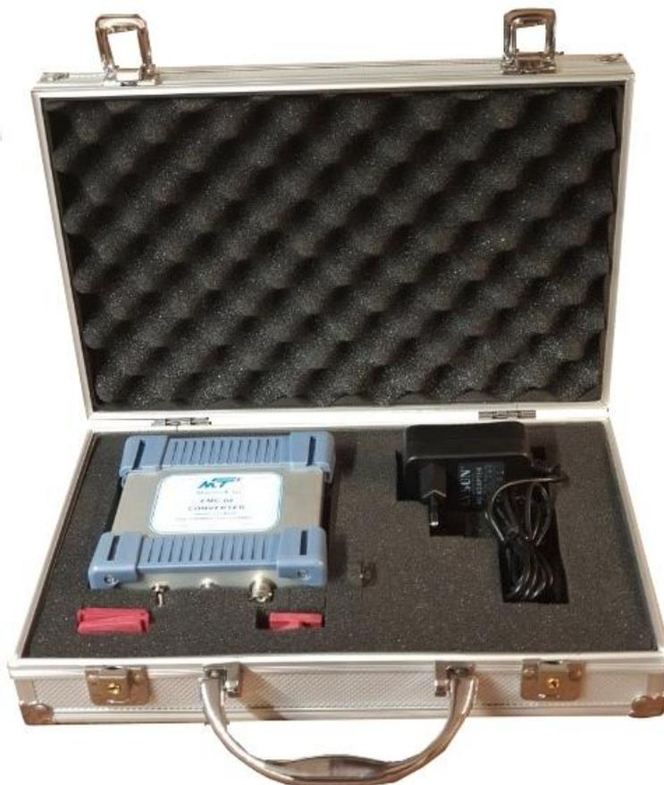
Il **CONVERTITORE 9 kHz MANTECK** permette di utilizzare analizzatori di spettro con frequenza minima selezionabile di 150 kHz estendendola a 9 kHz, conformemente alle future indicazioni che le normative nazionali ed internazionali prevederanno. La conversione avviene traslando la banda da 9 kHz / 150 kHz a 100,009 MHz / 100,150 MHz . La perdita d'inserzione è inferiore a 3 dB su tutta la banda trattata.
