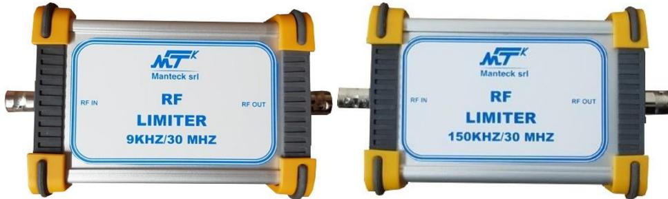
Il **LIMITER MANTECK** permette di effettuare prove di emissione della radiofrequenza condotta secondo la normativa vigente in completa sicurezza in quanto il suo intervento limita eventuali transienti che, provenienti dall'EUT, potrebbero danneggiare irreparabilmente l'analizzatore di spettro.
