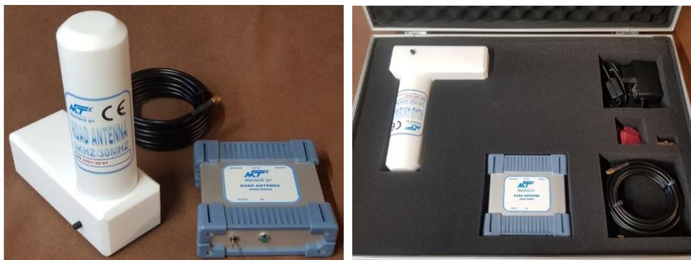
La ROAD ANTENNA permette di effettuare misure di campo elettrico nella banda di frequenza compresa tra 9 kHz e 30 MHz come previsto da alcune norme particolari e dedicate ad alcune famiglie di prodotti .
