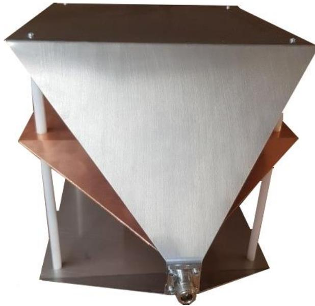
La Cella TEM (Transverse Electromagnetic Mode) permette di effettuare misure di emissioni irradiate e prove di immunità irradiata su schede elettroniche ed apparecchi elettronici di ridotte dimensioni.
