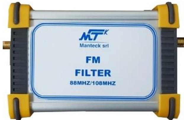
Questo filtro, interconnesso tra l'antenna e l'analizzatore di spettro permette di eliminare tutta la banda delle radio FM compresa tra **88 MHz** e **108 MHz** quando vengono effettuate misure in campo aperto e tali frequenze non permettono il rilevamento di eventuali disturbi emessi dall'apparecchio in prova.
