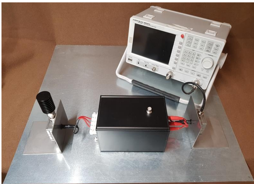
Configurazione del sistema secondo EN 61000-4-6
